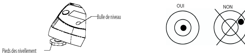
Figure 2-1, Mise à niveau de la balance,
